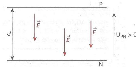
Une particule chargée, de charge électrique  $q$  dans un champ électrostatique subit une force électrique telle que :
