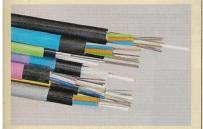
Pour les lignes principales des réseaux de télécommunication, les informations sont transmises dans des fibres optiques avec un grand débit.  Transmission dans un câble électrique
