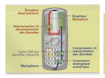
Lors d'un appel téléphonique, le son de la voix est capté par le microphone du téléphone qui le transforme en signal électrique (analogique). Ce signal est numérisé, c'est-à-dire transformé en valeurs discrètes, et transporté par des ondes électromagnétiques jusqu'aux antennes-relais des opérateurs.
